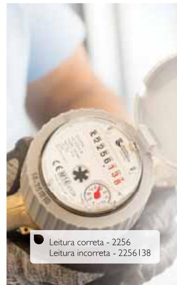
Para **verificar as condições de medição do fornecimento de água** deverá efetuar os seguintes procedimentos:
