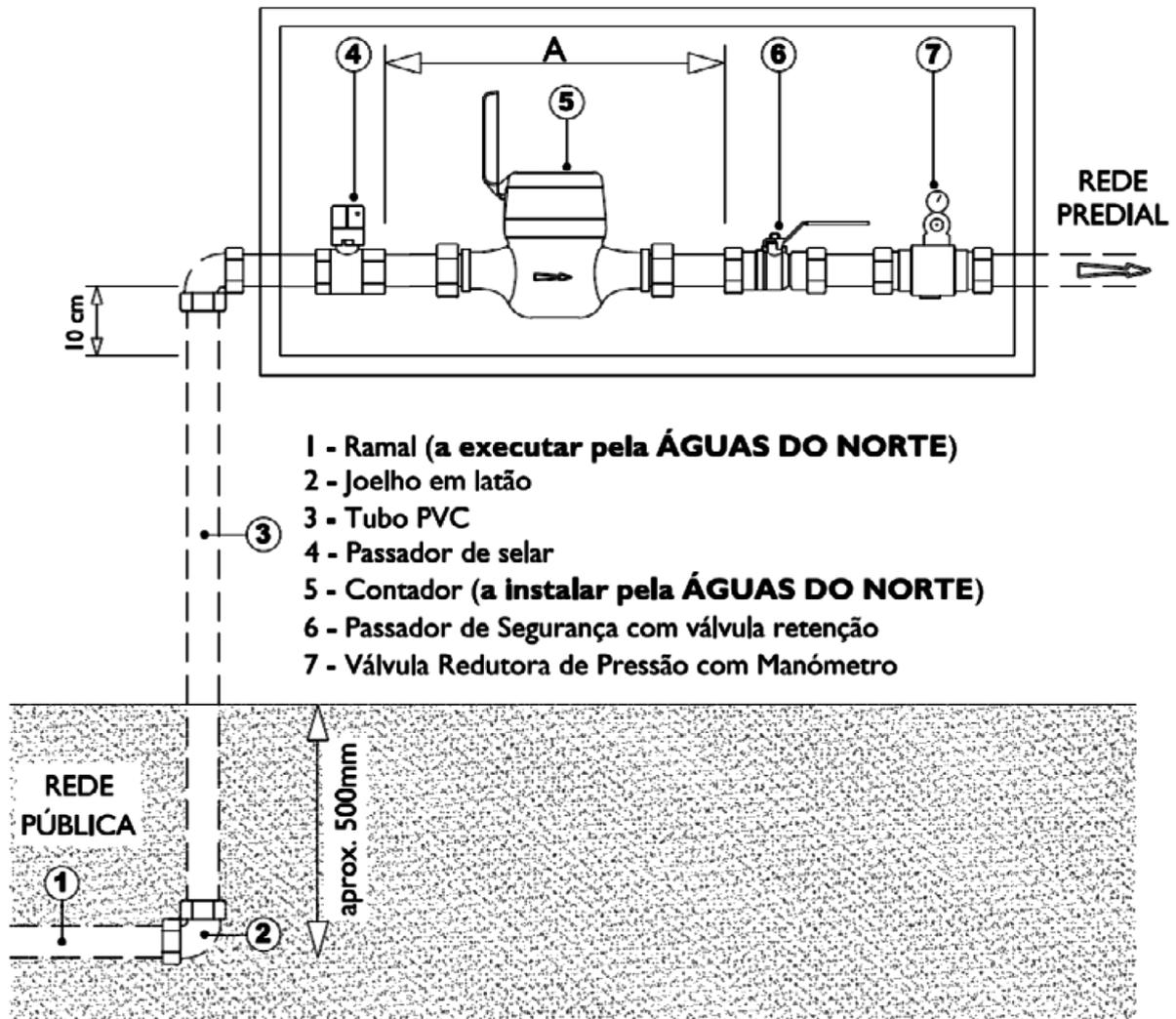
Para Contadores DN15 o espaço para instalação de contador (A) deve ser de 25 cm.
